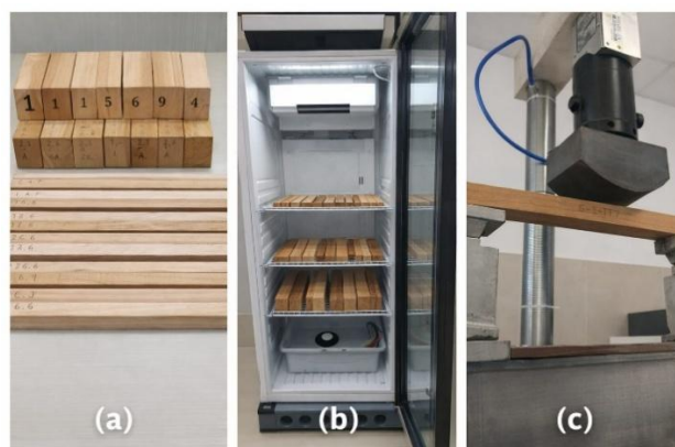
Figura 1. a. Probetas para ensayos mecánicos; b. Cámara climatizadora; c. Máquina de ensayos mecánicos (Ensayo de Flexión Estática)
