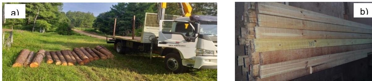
**Imagen 1.** Trozado de rollizos basales y transporte a la industria (a), tablas aserradas para ensayos no destructivos y destructivos (b).
