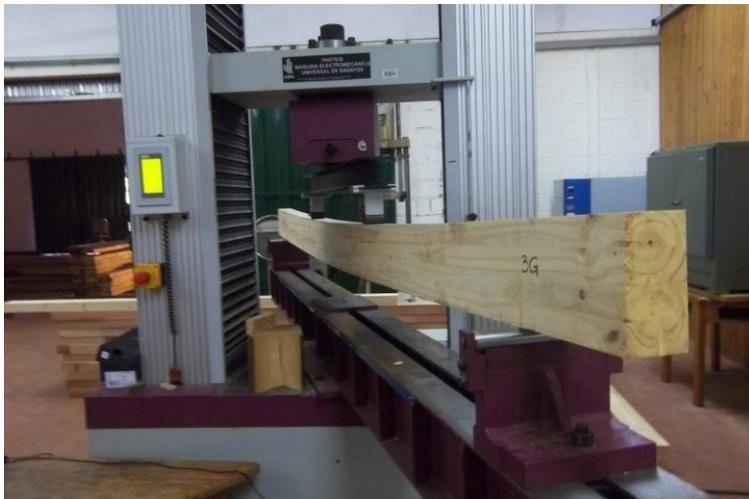
Foto 2. Máquina universal de ensayos electromecánica.
