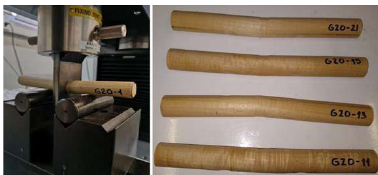
Figura 2. Ensayo de flexión en 3 puntos de tarugos
