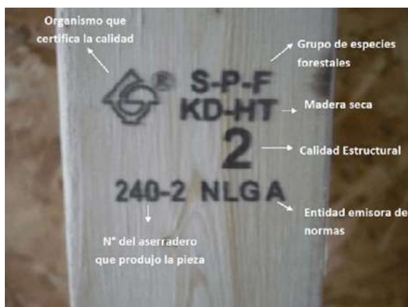
Figura 1. Ejemplo de rotulación, donde S-P-F significa que puede ser un S: Spruce (picea); P: pino; F: abeto.
